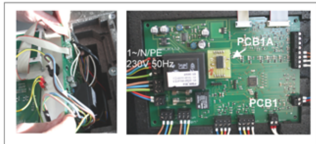
Abb. 4.12 Hauptplatine PCB1 mit Echtzeituhr-Platine PCB1A
